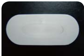
Annular Defect / 環状欠点
